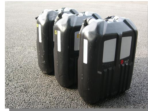
Apparecchi protezione della respirazione a circuito chiuso BG 4
