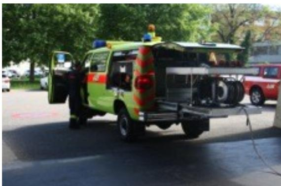
Messa in funzione del generatore del veicolo e la pompa, assemblaggio degli accessori alla motopompa Lukas (cesoia – divaricatore – cilindri di spinta).
